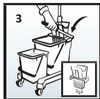
3 Поместить держатель с мопом в отжим вертикально вниз и надавить на рычаг до упора
